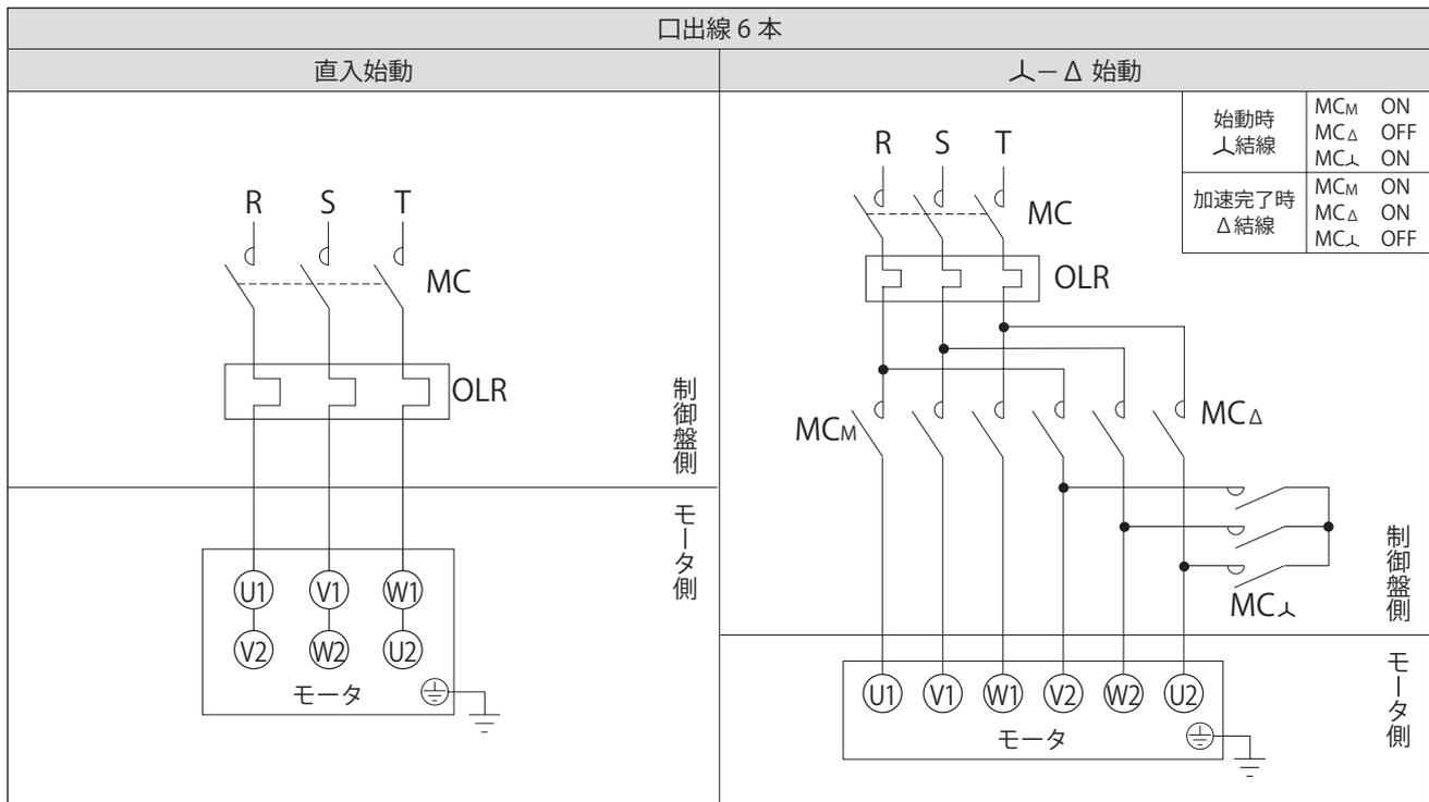
MC : 電磁接触器
