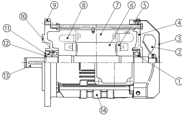
図 D1 モータ構造図 (例：N-100L 2.2kW 4P)
