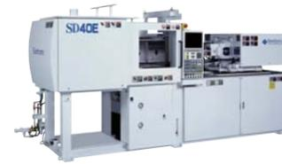
超精密ディスク専用射出成形機
