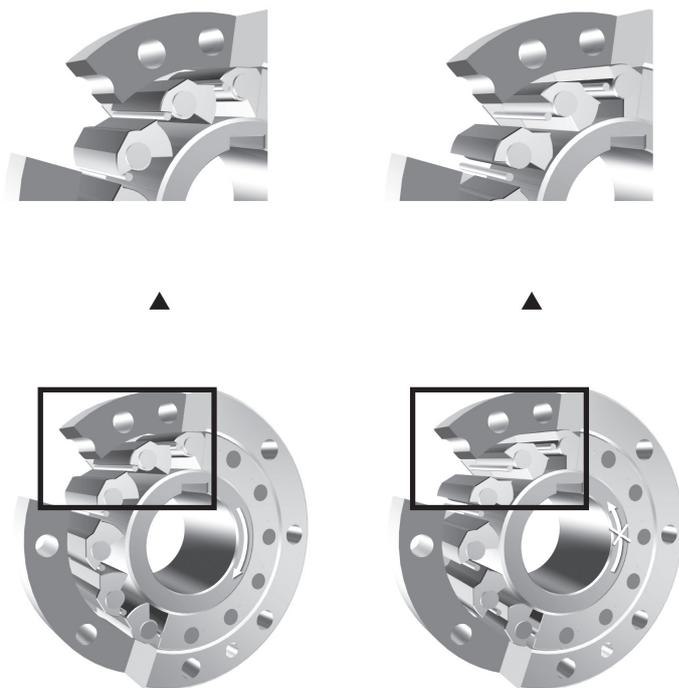
減速機の間軸にバックストップを直接マウントする内蔵型を採用しています。
