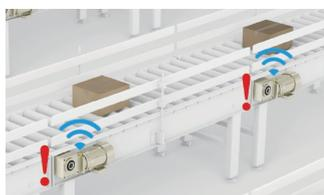
ギヤモータに振動センサを装着し、検知ユニット
