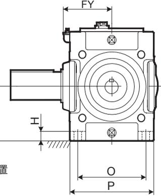
※サイズ9015～9030で速比6.3または7.1の場合には給油口および空気抜栓の位置が変わります。図1をご参照ください
