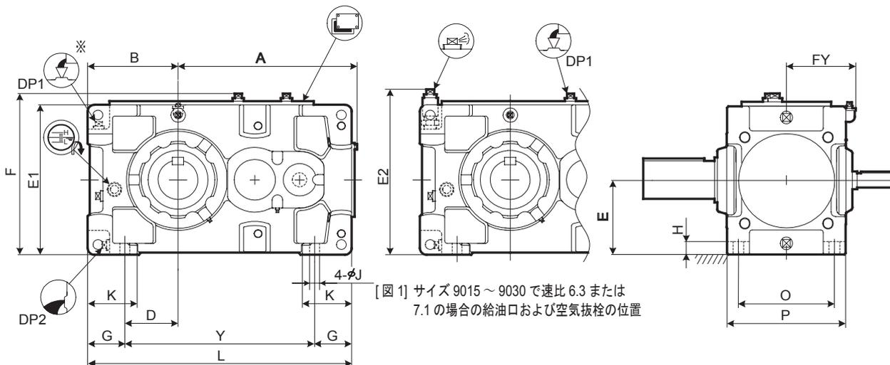
[図 1] サイズ 9015 ~ 9030 で速比 6.3 または 7.1 の場合の給油口および空気抜栓の位置
