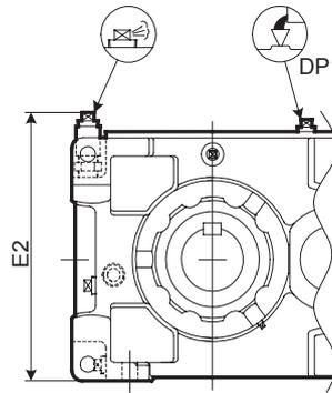
[図1] サイズ9015～9030で速比6.3または7.1の場合の給油口および空気抜栓の位置
