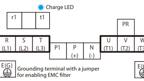
**Fig.5 400V class:HF4324-030~HF4324-055(30~55kW)**
