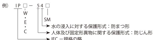
S 水浸入に対する保護形式の試験をモータの停止中に実行する場合。
