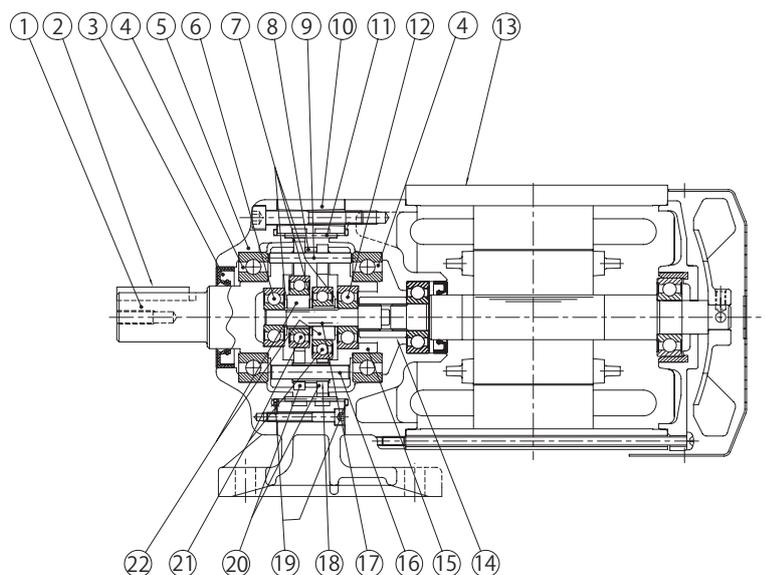
図E1 脚取付・CNHMタイプ・サイクロ減速機構造機種
