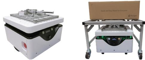
KeiganALIと台車を自動脱着するアタッチメントです。荷物を載せた台車を自動で搬送することができるため、お客様がKeiganALIに荷物を載せたり台車を脱着する必要がありません。また、様々な形状の台車を運ぶことができ、幅広い用途に対応します。
