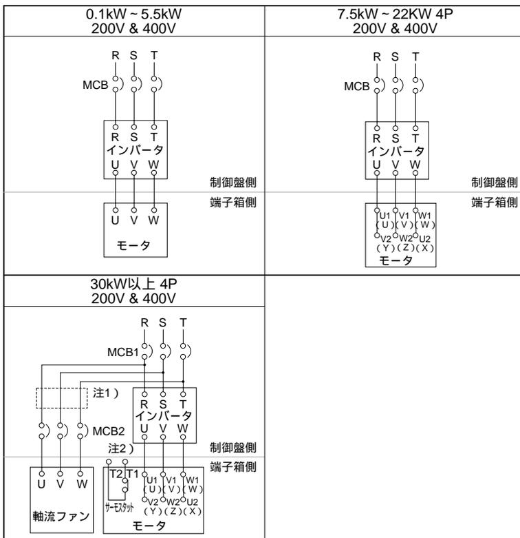
AFモータはインバータ用として設計されている為、小容量帯は人結線、中容量以上は結線ですが商用電源による人-切換運転も可能となっています。
