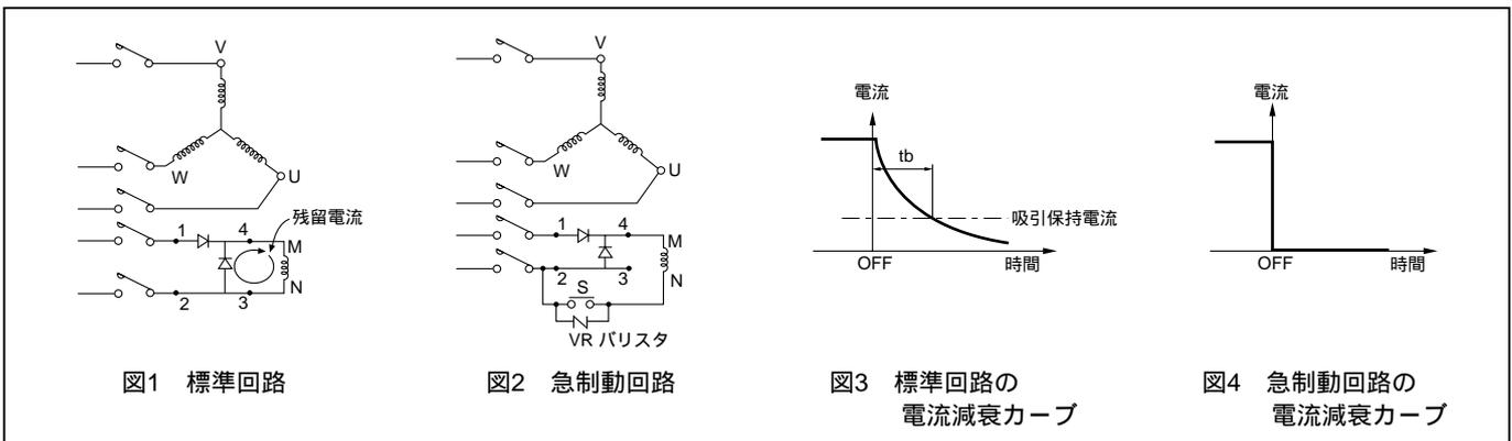
ブレーキコイルはインダクタンスLがあるため、図1の標準回路の場合、電源OFFにしてもLに蓄えられたエネルギーにより残留電流が流れます。この残留電流の減衰カーブは図3の様になります。そこで図2の急制動回路に接続し電源OFFと同時にSも開放すれば、ブレーキコイルとの閉回路が出来ないため、残留電流は図4の如く流れなくなります。
